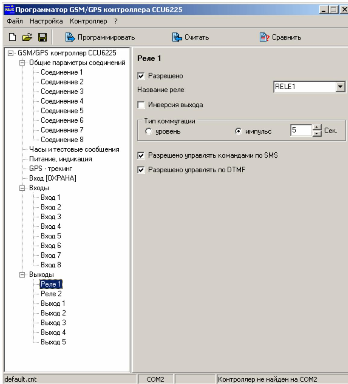
Рисунок 13. Типовая настройка параметров выходов
