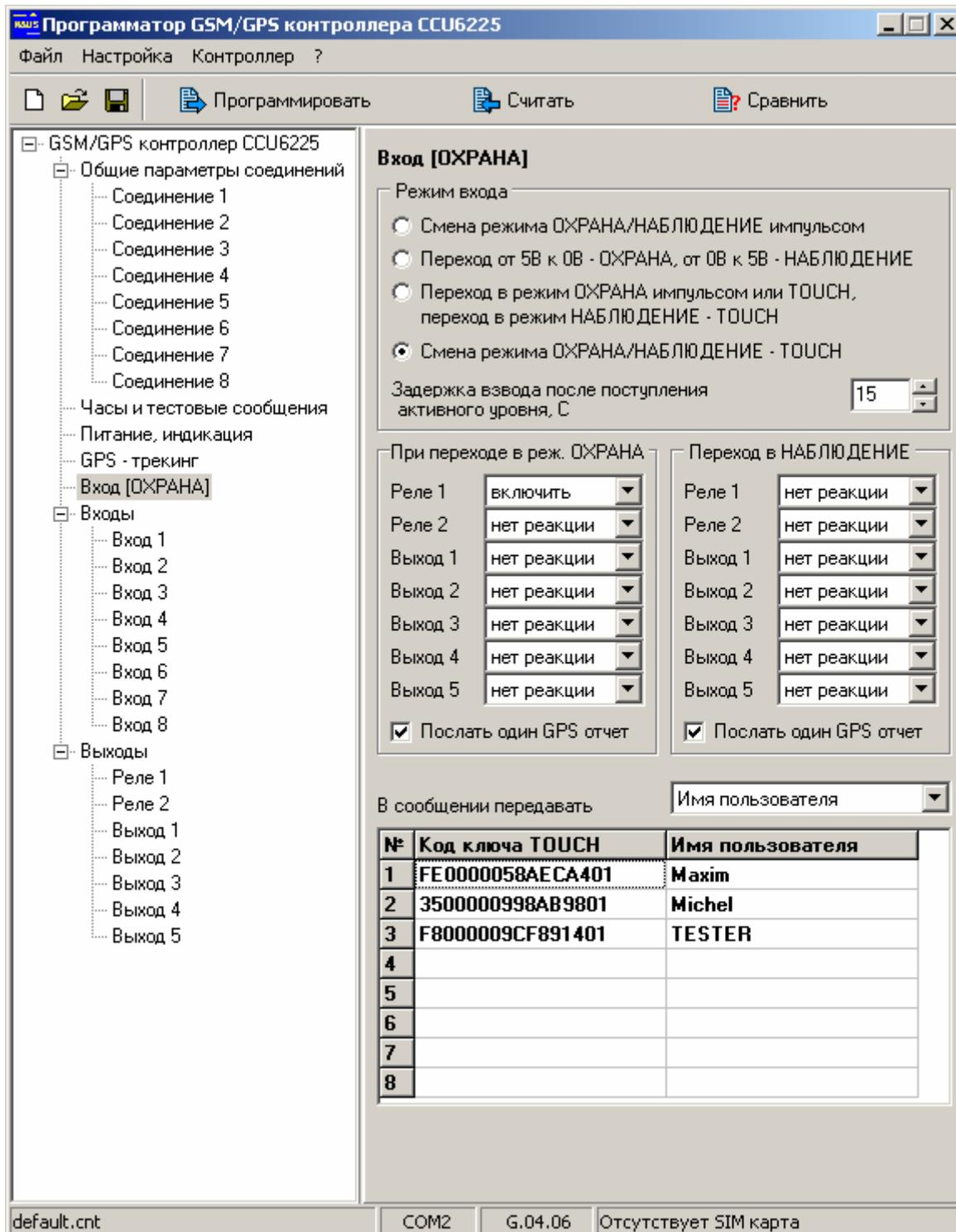
Рисунок 11. Настройка параметров входа "ОХРАНА"
